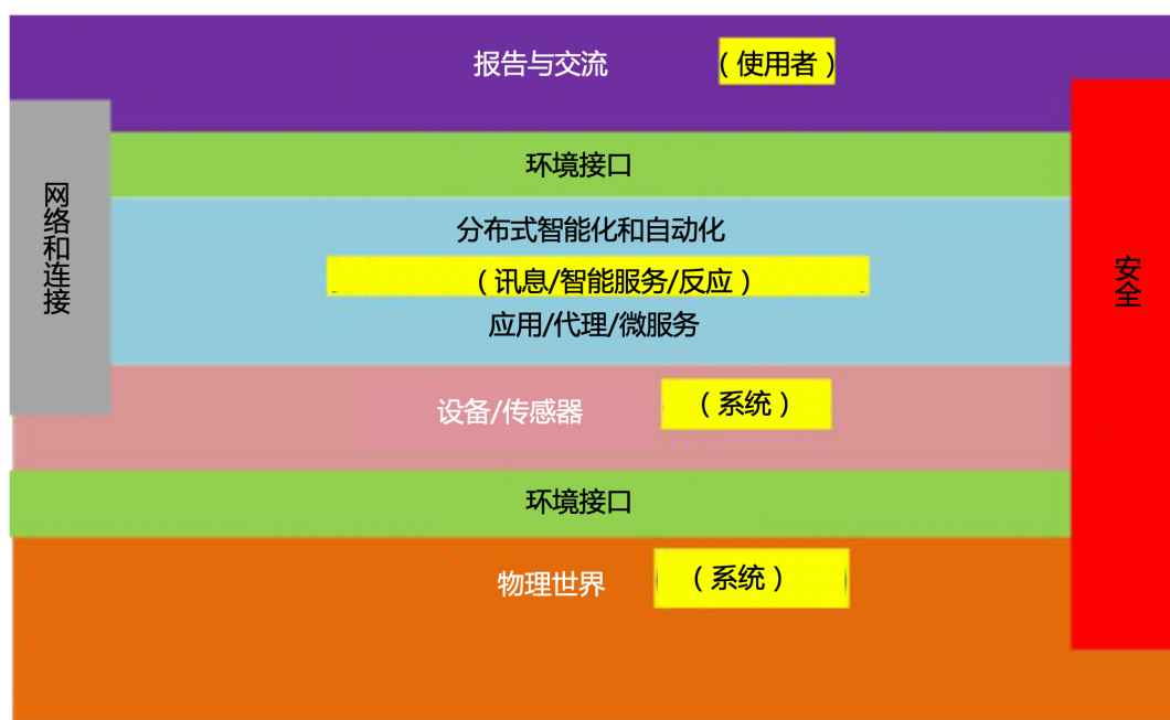
图1: 基于ISO/IEC定义的物联网堆栈
